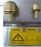
Después de alcanzar la presión de vacío programada, el producto es llenado con un gas inerte, tal como CO<sub>2</sub>, Nitrógeno, Oxígeno, o una mezcla de ellos. Esta función es controlada ya sea por-medio-de-tiempo por medio-de-sensor.
